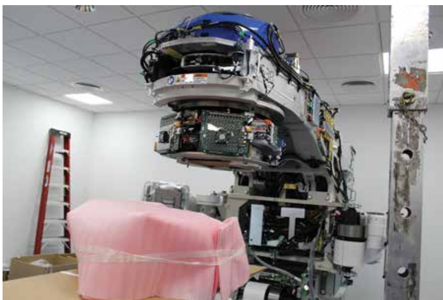
Akcelerator w fazie montażu
