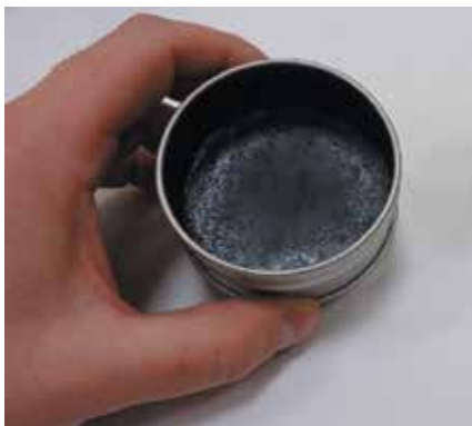
FOT. 1. ASFALT MODYFIKOWANY GUMĄ (FOT. A. KURPIEL)
